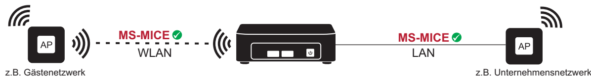
Infrastrukturmodus & LAN MS-MICE aktiv auf WLAN & LAN
